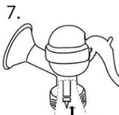
7. Installieren Sie das Ventil fest auf den Stab des Geräts
